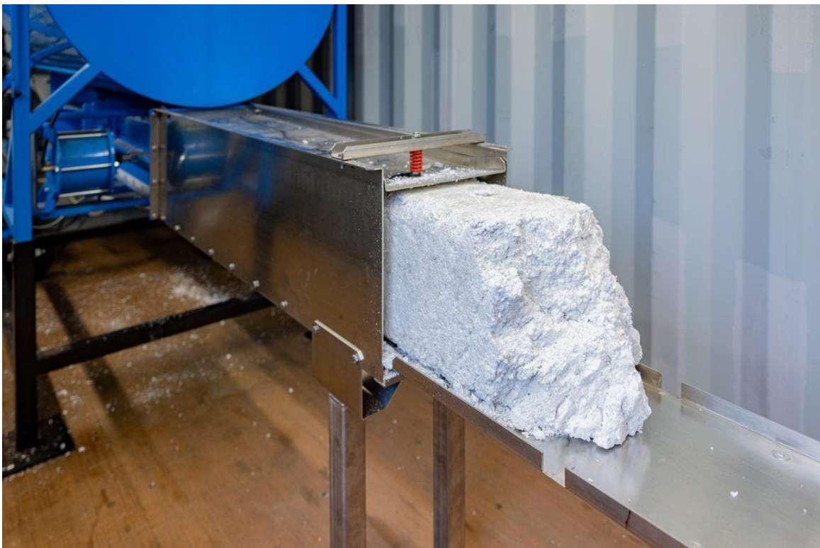
Flamingo-anlægget knuser og komprimerer materialet med 80 %, hvilket giver en væsentlig reduktion af både transport og CO 2 -belastning
